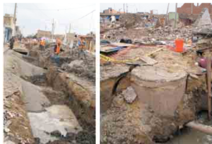
F-4.10.2 Características del suelo de Pisco: suelo arenoso con la napa freática cerca de la superficie.
